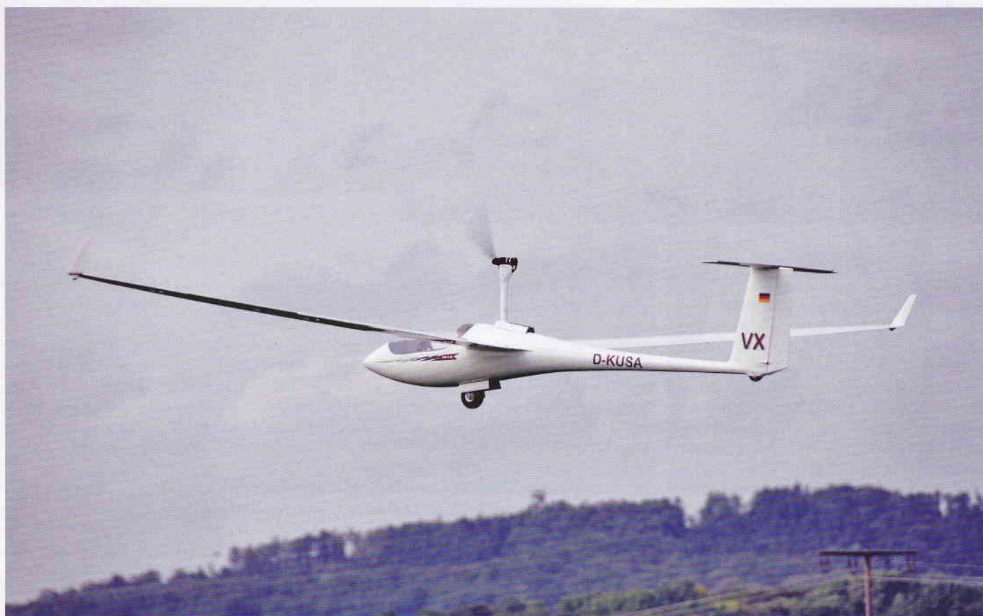
Unabhängigkeit bietet das Modell mit dem leistungsstarken Einblatt-Klapptriebwerk von Florian Schambeck: Triebwerk ausfahren, Gas geben und abheben · Highspeed-Überflug mit geöffneten Wasserballastventilen. Es handelt sich hier tatsächlich um das Modell im Maßstab 1:2,5!
